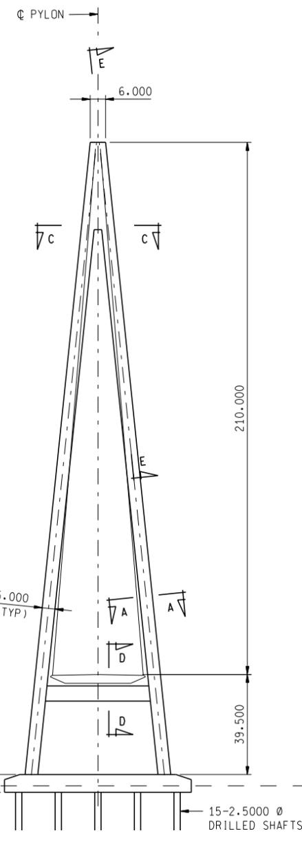
A - SHAPE PYLON ELEVATION
