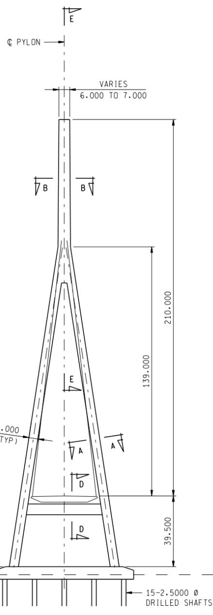
Y - SHAPE PYLON ELEVATION
